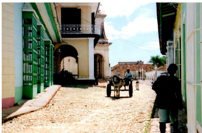
道路中央部が排水路のスペイン風街路
